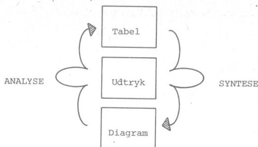
**ANALYSE:** Med udgangspunkt i et givet diagram for en digital funktion opskrives et udtryk for funktionen. Udtrykket reduceres så meget som muligt, hvorefter funktionstabellen opskrives. Ved hjælp af tabellen kan man svare på alle spørgsmål angående funktionens virkemåde.
