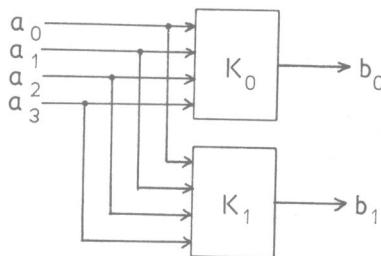
Man kan tit spare en del gates ved at lade  $K_0$  benytte nogle af mellemresultaterne i  $K_1$  og omvendt. Derfor er det ikke helt realistisk, når ovenstående tegning antyder, at K er sammensat af to separate netværk. Normalt tegnes blokdia-grammet simpelthen således:
