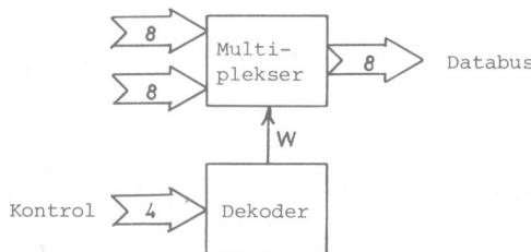
Udgangssignalet fra dekoderen kunne også sættes til at styre en *demultiplekser*. En demultiplekser er blot en omvendt multiplekser, idet den er forsynet med én indgangsbuss og to eller flere udgangsbusser.
