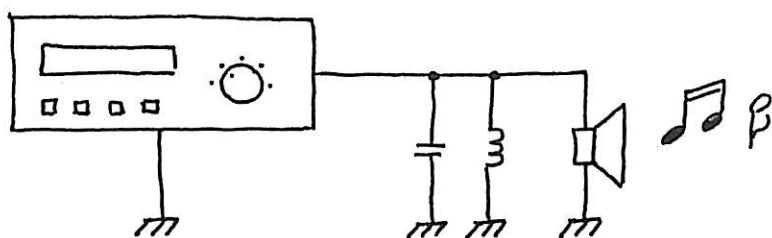
Et andet eksempel er transmisjonen af radiosignaler, som opfanges af en antenné, og som derfra sendes via en parallelkreds til en diodemodtager:
