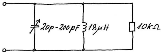
Parallelkreussen ovenfor er udstyret med en variabel kondensator, således at resonansfrekvensen kan varieres.
