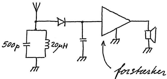
Antennens indre modstand og diodens belastning af parallelkredsen muldner vi til at give en nettomodstand på  $10\text{ k}\Omega$  parallelt over kredsen:
