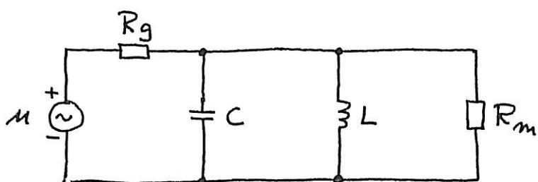
Vi skal mest interessere os for, i hvor høj grad signaler med variende frekvens slipper igennem systemet fra generatoren til
