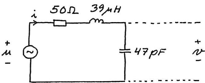
Vekselspændingsgeneratoren leverer en vekselspænding med amplituden 1 volt. Den frekvens justeres indtil strømmens amplitude er maksimal.
