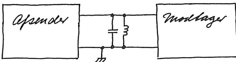
Den ene af de to ledninger, der transporterer signalet, er ofte forbundet til apparaternes chassis, og er signalmæssigt "død". Denne ledning betegnes med m.
