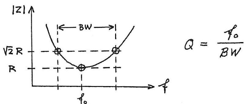
Det er indlysende, at de tre størrelser,  $f_0$ ,  $BW$  og  $Q$  må afhænge af 2-poleus komponenter,  $R$ ,  $L$  og  $C$ . I det følgende vil vi nøllede formler, der
