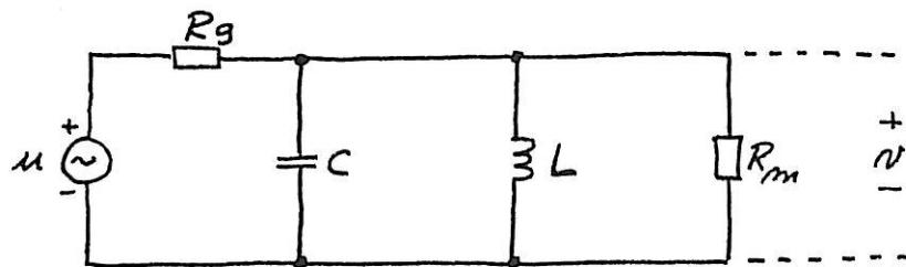
forudsættes, at generatorenens amplitude er konstant. Da er amplituden af  $v$  proportional med modulus af impedansen af parallelresonanskredsen
